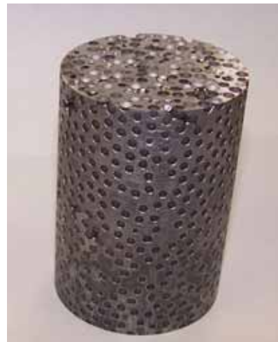
Σύνθετο «αφρώδες» υλικό φτιαγμένο από 100% χάλυβα, χρησιμοποιώντας σκόνη δημιουργημένη από τεχνική μεταλλουργίας.
